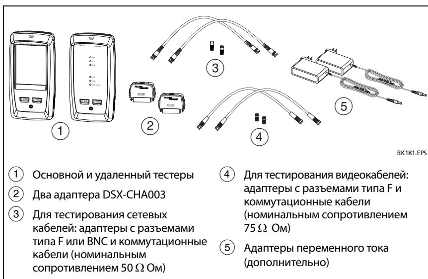
Рис. 23. Оборудование для тестирования коаксиальных кабелей
