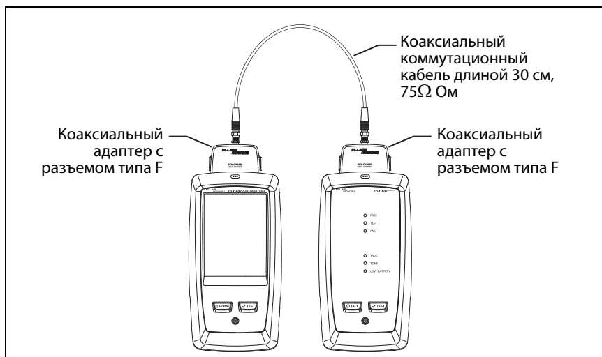
Рис. 22. Эталонные соединения для тестирования коаксиальных кабелей
