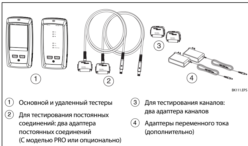
Рис. 13. Оборудование для автоматического тестирования витых пар
